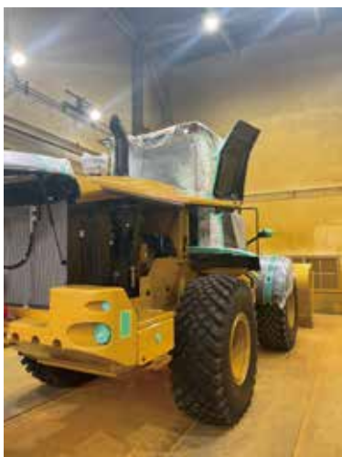
↑ 照明ライト関連の養生
